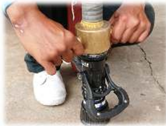
การต่อหัวฉีดดับเพลิงแบบฝอย
