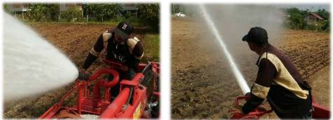
รูปการใช้หัวฉีดน้ำด้านบนตัวรถ
