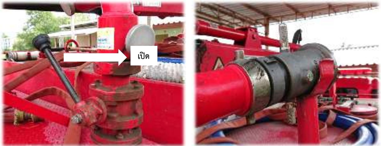
รูปหัวฉีดด้านบนรถดับเพลิง
